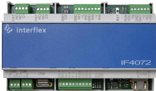
Der Controller IF-4072 verbindet das Host-System mit bis zu 16 Interflex Terminals für Zeiterfassung oder Zutrittskontrolle. Die Steuerung und Überwachung z.B. von Türen ist über die zwei integrierten Relais und die vier Eingangskontakte möglich. Der Controller ist in vier Ausführungen zum Anschluss von zwei, vier, acht oder sechzehn Terminals erhältlich.
